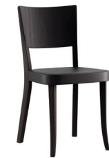
1-790 haefeli Max Ernst Haefeli, 1926 Sitz und Rücken Formsperrholz, Hinterfüsse und Sitzzarge massiv gebogen B41, T49, H82, SH46
